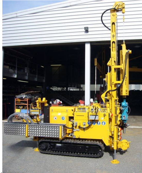
Foreuse équipée d'un pénétromètre dynamique type B
