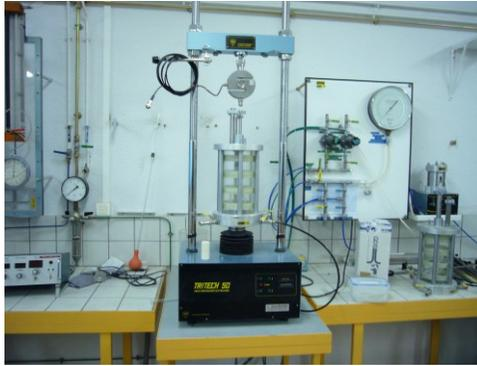
Sur sa surface latérale, l'éprouvette est recouverte d'une membrane souple et imperméable. A la partie supérieure de l'éprouvette est placée une embase rigide munie ou non d'un disque drainant, sur laquelle vient s'appuyer un piston.
