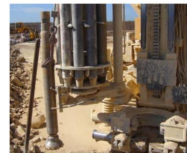
On distingue 2 phases, la percussion et le soufflage. Ce mode de foration est peu utilisé en géotechnique.
